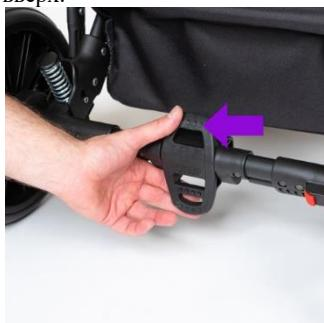
25. Жесткость пружинного амортизатора регулируется переключателем, расположенным непосредственно под задней осью:
