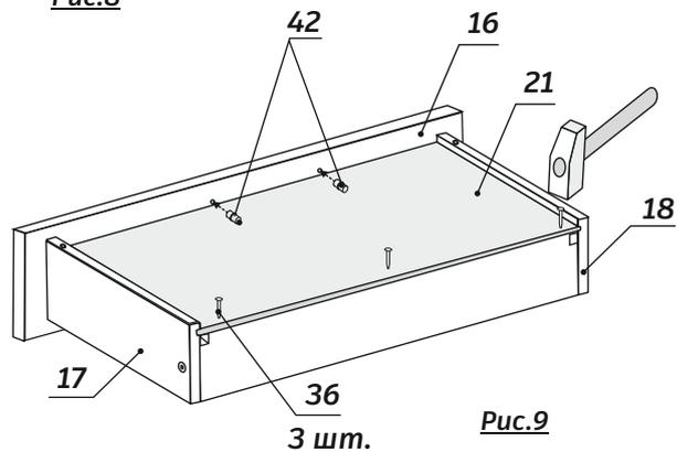
Перед тем, как вкручивать шурупы, необходимо выровнять диагонали "b" и обеспечить перпендикулярность между деталями ящика. (см. рис.10)
