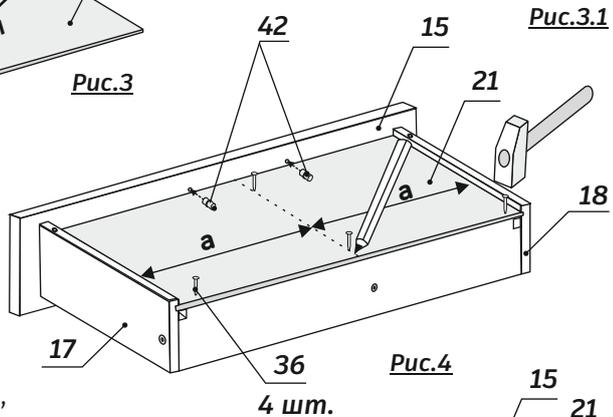
Перед тем, как вкручивать шурупы, необходимо выровнять диагонали "b" и обеспечить перпендикулярность между деталями ящика. (см. рис.5)
