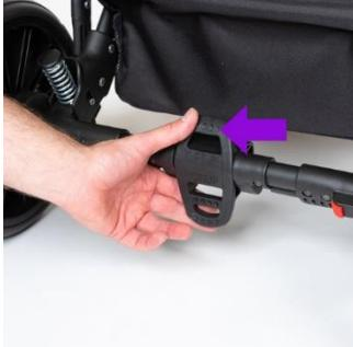
15. Для регулировки основного амортизатора поверните его верхнюю часть и зафиксируйте нижнюю:
