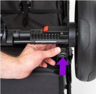
16. Чтобы снять заднее колесо нажмите кнопку и потяните колесо:
