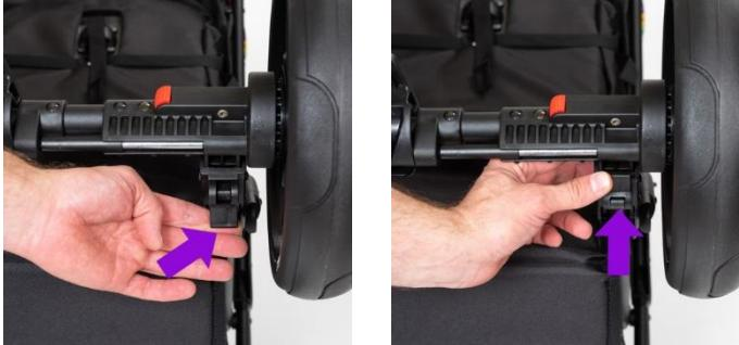
32. Для регулировки основного амортизатора поверните его верхнюю часть и зафиксируйте нижнюю:
