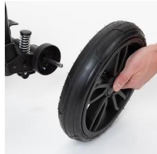
29. Чтобы снять переднее колесо нажмите кнопку и потяните колесо:
