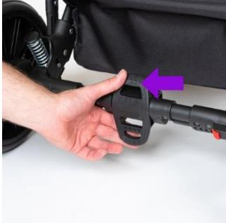
26. Жесткость пружинного амортизатора регулируется переключателем, расположенным непосредственно под задней осью:
