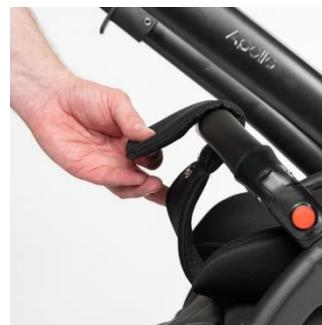
16. Для установки капюшона на прогулочный блок используйте ответные крепления:
