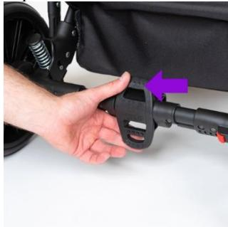
20. Жесткость пружинного амортизатора регулируется переключателем, расположенным непосредственно под задней осью:
