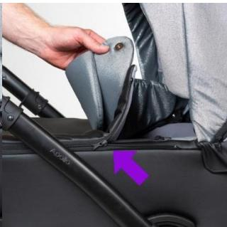
11. Чтобы снять люльку необходимо нажать на фиксаторы и потянуть люльку вверх:
